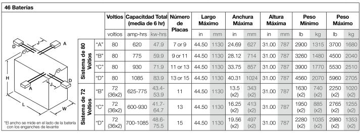
Lugar del Conector / Largo (J): A/15" (A/381mm) para todos los tamaños de batería a excepción de la de 80 Voltios "D" que requiere D/22" (D/559 mm). Conectores Estándar: Todas las Baterías de 80 Voltios = SB350 Negro, Todas las Baterías de 72 Voltios = SB350 Gris.
